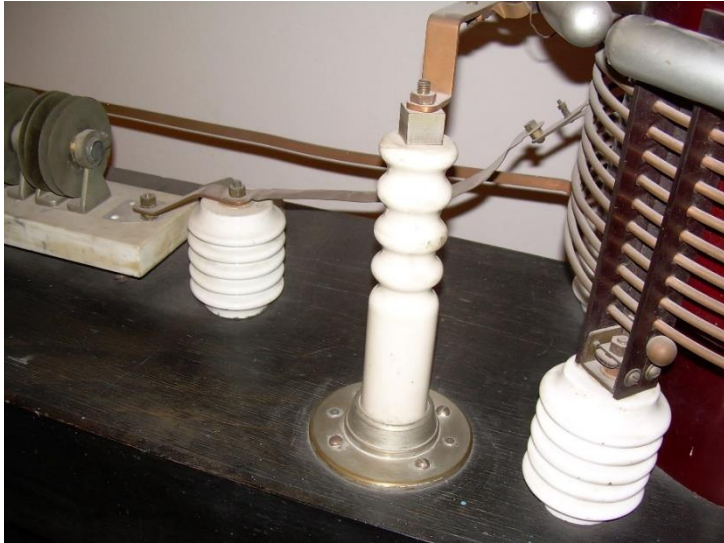
Figura 7.2 Isolatori in ceramica
