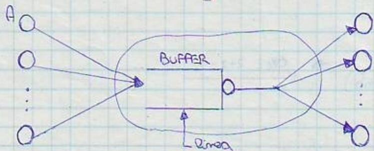
Il controllo di flusso abbiamo visto che serve ad impedire che per esempio A sommerà A'. Si noti che oltre B, rete può essere sommersa.
