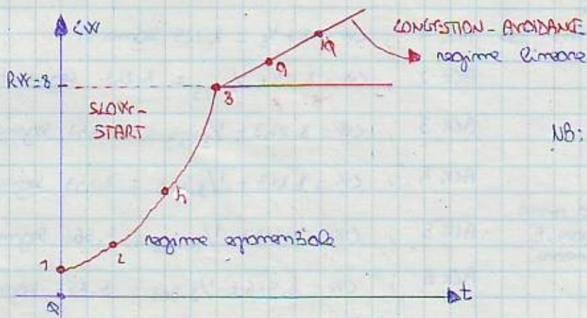
N.B.: La CW aumenta di un segmento se si riceve un ACKNOWLEDGE (ACK segment) in base di CONGESTION-AVOIDANCE.
