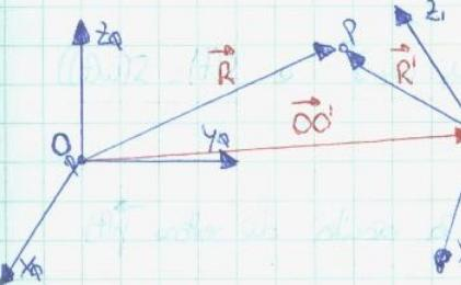
$$v' = \frac{dr'}{dt} = \frac{dx'}{dt} \vec{i}_x + \frac{dy'}{dt} \vec{i}_y + \frac{dz'}{dt} \vec{i}_z, \text{ definiamo } \underbrace{\vec{v}_t = \vec{v} - \vec{v}'}_{\Rightarrow \text{ se } \omega = 0} = \text{velocità di traslazione}. \text{ In particolare:}$$
