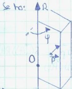
$$\vec{v} = \omega \times (\vec{P} - \vec{O}) \text{ con } \omega = \text{velocità angolare} \text{ e } \omega = \dot{\theta} R$$
