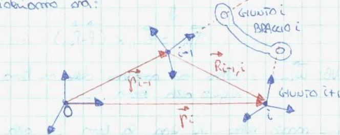
Perciò:  $\vec{p}_i = \vec{p}_{i-1} + R_{i-1,i} v_{i-1,i} + \vec{w}_{i-1} \times R_{i-1,i} r_{i-1,i}$
