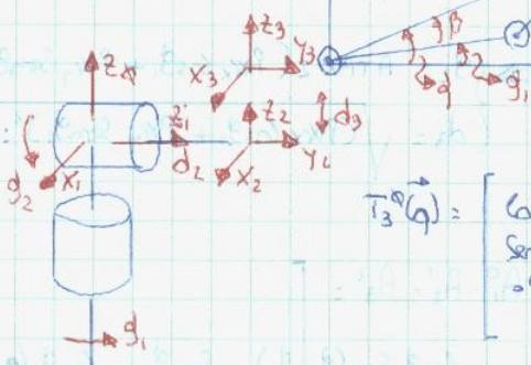
$$T_3(g) = \begin{bmatrix} \cos g_1 & \cos g_2 & -\sin g_1 & d \cos g_1 \\ \sin g_1 & \cos g_2 & \cos g_1 & d \sin g_1 \\ 0 & -\sin g_2 & 0 & d \cos g_2 \\ 0 & 0 & 0 & 1 \end{bmatrix}$$
