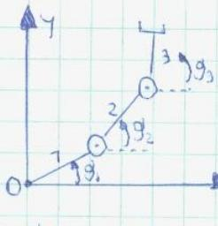
$$\vec{J}(q) = \begin{bmatrix} \vec{z}_0 \times (\vec{P} - \vec{P}_0) & \vec{z}_1 \times (\vec{P} - \vec{P}_1) & \vec{z}_2 \times (\vec{P} - \vec{P}_2) \end{bmatrix} \text{ con } \vec{P}_0 = \begin{bmatrix} q \\ q \\ q \end{bmatrix}$$
