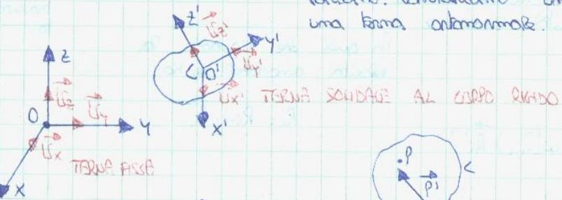
Sia  $R(t)$  la matrice orientamento della terna saldata rispetto alla terna fissa, al tempo  $t$ .
