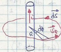
$$\vec{B} \cdot d\vec{s} = \frac{\mu_0 i}{2\pi R} \vec{U}_\phi \cdot d\vec{s} \Rightarrow \vec{B} \cdot d\vec{s} = \frac{\mu_0 i}{2\pi} d\phi$$
