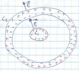
Questa figura illustra il fenomeno di induzione completa. In sostanza tutte le linee di forza che partono da  $C_1$  terminano su  $C_2$ .
