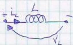
Anch'esso è un bipolo caratterizzato dalla **induttanza** L. Tale induttanza si misura in **Henry (H)**. Gli induttori impiegati in elettronica hanno delle induttanze da vario, da millihenry (mH) ai microhenry (μH). Quando un conduttore, una spira, o un solenoide o un circuito elettrico è percorso da corrente si crea un flusso magnetico ad esso connesso. Nel caso in cui varia la corrente nel circuito, varia anche il flusso e pertanto, per es. legge di Faraday:
