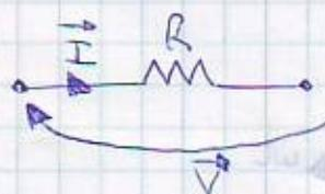
Nel regime sinusoidale la resistenza R viene sostituita dalla impedenza  $\hat{Z}$ . L'impedenza di un bipolo è definita come il rapporto tra la tensione ai capi del bipolo e la corrente che lo attraversa. Formalmente si scrive:
