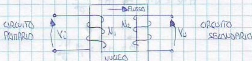
I due circuiti sono avvolti in spine di numero opposto su uno stesso nucleo di materiale ferromagnetico. Siccome i materiali ferromagnetici possiedono un'elevata permeabilità magnetica, facilitano il passaggio del flusso magnetico dal circuito primario verso il circuito secondario. Sia:
