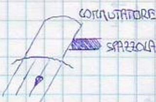
Durante la rotazione, le spazzole vengono mantenute in contatto con il commutatore in modo che possa circolare corrente. Il commutatore è composto da segmenti di nome separato da isolanti come per esempio la mica. Graficamente si ha:
